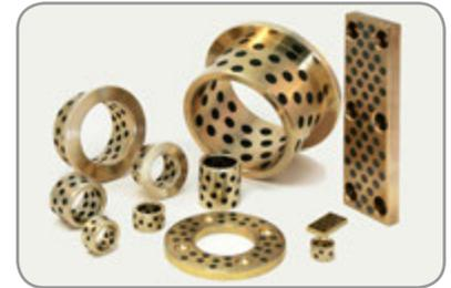
Gleitlager aus gedrehter Gußbronze oder Eisen sind technisch und wirtschaftlich eine interessante Lösung. Sie eignen sich besonders bei Anwendungen mit hohen Belastungen und sind auch bei hohen Temperaturen gut einsetzbar. Ausführungen mit Schmiernuten oder Festschmierstoffen in der Laufschiene ermöglichen einen vielfältigen Einsatzbereich. Geeignet für lineare, rotierende und oszillierende Bewegungen.
