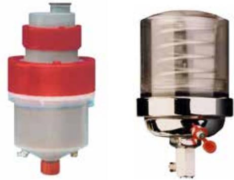
Automatische Schmierstoffgeber versorgen über einen langen Zeitraum die Lagerstelle mit der nötigen Menge an Schmiermittel. Die Schmiermittelabgabe erfolgt gleichmäßig und kann über ein Ventil oder elektronisch geregelt werden. Der Typ und die Größe des Schmierstoffgebers müssen entsprechend der zu versorgenden Lagerstelle ausgewählt werden.
