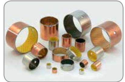
Gleitlager mit Schmieraschen in der Laufschiene, einbaufertig. Ausführung nach ISO 3547 (DIN 1494/Teil 2). Geeignet für rotierende und oszillierende Bewegungen im Mischreibungsbereich bei fettgeschmierten oder ölgeschmierten Anwendungen. Typische Anwendungen zum Beispiel in Landmaschinen, Baumaschinen, Schi- und Materialliften, Forstgeräten, Fahrzeugbau, Baumaschinen und Bahnbaumaschinen.
