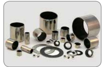
Gleitlager aus dreischichtigem Verbundwerkstoff (Tragrücken, Sinterbronze, PTFE-Gleitschichte), selbstschmierend, wartungsfrei und einbaufertig. Ausführung nach ISO 3547 (DIN 1494). Einsatz bei hohen Lagerdrücken und niedrigen Gleitgeschwindigkeiten, Trockenlauf mit niedrigem Reibungskoeffizient und geringem Verschleiß, auch für geschmierte Lagerstellen einsetzbar. Gute chemische Beständigkeit. Geeignet für Rotation, Oszillation und Axialbewegungen. Keine Verschweißneigung mit Metall.
