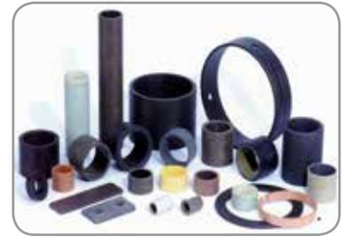
Gleitlager aus Verbundwerkstoffen. Der Tragrücken mit Epoxyharz getränkten Glasfasern ist hoch belastbar. Die Gleitschicht besteht aus gewickelten PTFE-Fasern oder anderen Fasern mit guten tribologischen Eigenschaften. Diese spezielle Struktur ermöglicht bei Trockenlauf besonders niedrigen Verschleiß und niedrigen Reibungskoeffizienten unter hoher Last und niedrigen Gleitgeschwindigkeiten.
