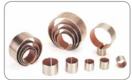
Gleitlager aus dreischichtigem Verbundwerkstoff (Stahlrücken, Sinterbronze, Gleitschichte aus PTFE-Polymerfasermischung), selbstschmierend und wartungsfrei, einbaufertig. Ausführung nach ISO 3547 (DIN 1494). Einsatz bei hohen Lagerdrücken und niedrigen Gleitgeschwindigkeiten, Trockenlauf mit niedrigem Reibungskoeffizient und geringem Verschleiß. Auch für geschmierte Lagerstellen (Öl, Fett) einsetzbar.
