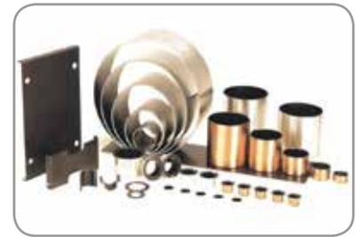
Gleitlager aus selbstschmierendem Verbundwerkstoff, mit metallischem Tragrücken und einem PTFE-Compound als Gleitschichte, einbaufertig. Einsatz bei hohen Lagerdrücken und niedrigen Gleitgeschwindigkeiten. Gute chemische Beständigkeit. Geeignet für Rotation und Oszillation, auch für Axialbewegungen geeignet.
