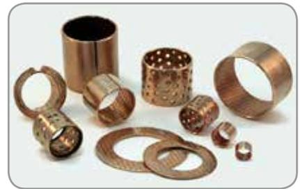
Gleitlager aus massivem Bronzeband CuSn8 und Schwerlastbronze mit Schmieraschen. Geeignet für Einsätze mit hohen Belastungen. Ausführungen mit rautenförmigen Schmieraschen oder Lochdepots in der Laufschiene, einbaufertig. Weiters sind Ausführungen nach Kundenzeichnung mit Schmiernuten u.ä. lieferbar. Geeignet für rotierende und oszillierende Bewegungen im Mischreibungsbereich bei fettgeschmierten Anwendungen.
