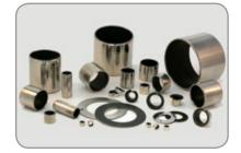
Gleitlager aus dreischichtigem Verbundwerkstoff (Tragrücken, Sinterbronze, PTFE-Gleitschichte), selbstschmierend, wartungsfrei und einbaufertig. Ausführung nach ISO 3547 (DIN 1494). Einsatz bei hohen Lagerdrücken und niedrigen Gleitgeschwindigkeiten, Trockenlauf mit niedrigem Reibungskoeffizient und geringem Verschleiß, auch für geschmierte Lagerstellen einsetzbar. Gute chemische Beständigkeit. Geeignet für Rotation, Oszillation und Axialbewegungen. Keine Verschweißneigung mit Metall.
