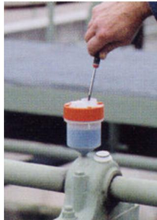
Die Laufzeit oder Fettabgabemenge wird mit den DIP-Schaltern manuell je nach Bedarf eingestellt
