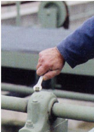
Den Schmiernippel an der Schmierstelle mit Schraubenschlüssel oder ähnlichem Werkzeug herausschrauben
