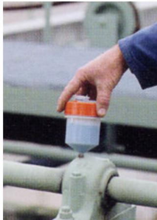
Den Verschlussstöpsel vom Auslass abnehmen. Schmierstoffgeber ggf. mit Adapter auf das Lager setzen und einschrauben
