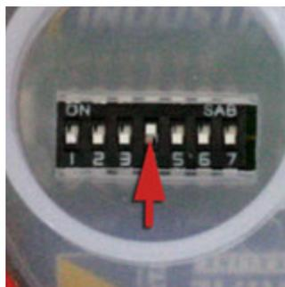
Jede Dosierung über DIP-Schalterkombination möglich
