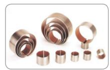
Gleitlager aus dreischichtigem Verbundwerkstoff (Stahlrücken, Sinterbronze, Gleitschichte aus PTFE-Polymerfasermischung), selbstschmierend und wartungsfrei, einbaufertig. Ausführung nach ISO 3547 (DIN 1494). Einsatz bei hohen Lagerdrücken und niedrigen Gleitgeschwindigkeiten, Trockenlauf mit niedrigem Reibungskoeffizient und geringem Verschleiß. Auch für geschmierte Lagerstellen (Ol, Fett) einsetzbar.
